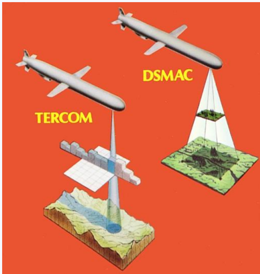
תמונה 3 – ניוט מכ"מי (TERCOM) ואופטי (DSMAC) | מקור: ausairpower.net
