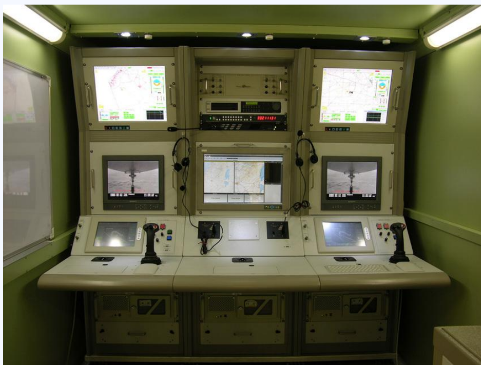
תמונה 2 – תחנת שליטה ובקרה – GCS – Ground Control Station | מקור: Aeronautics, 2007
