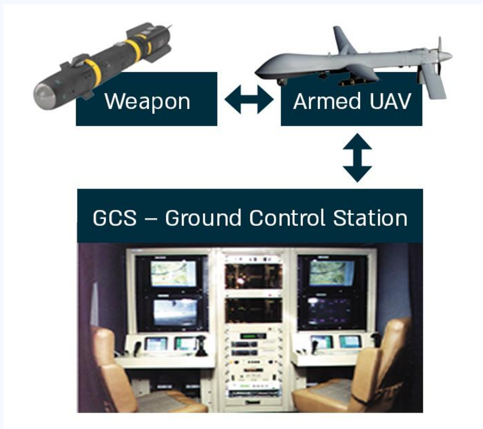
תרשים 1 – מרכיבי מערכת נשק של UCAV פרדטור
