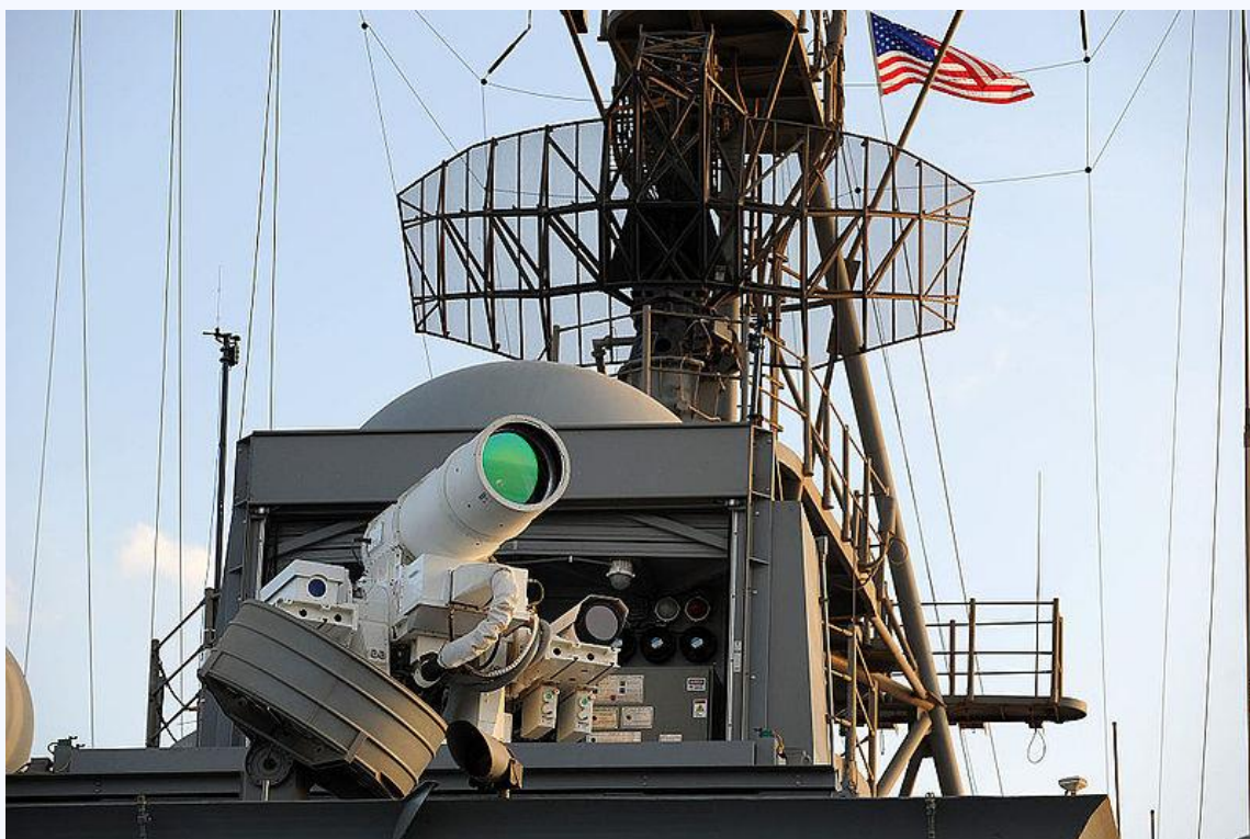
איור מס' 2: לייזר מצב מוצק מבצעי LaWS בהספקים 15-50 קילו-וואט מוצב על ספינת הצי USS Ponce | מקור: https://en.wikipedia.org/wiki/AN/SEQ-3_Laser_Weapon_System
